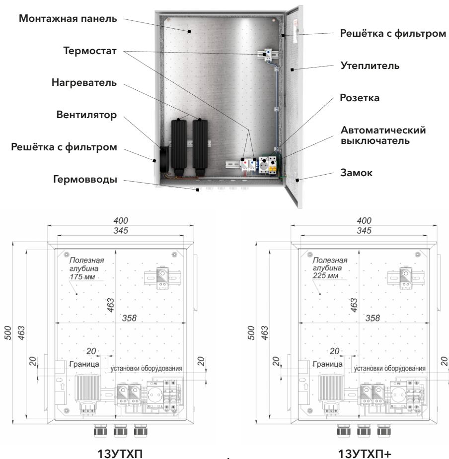
Схема компоновки и устройства термошкафа
