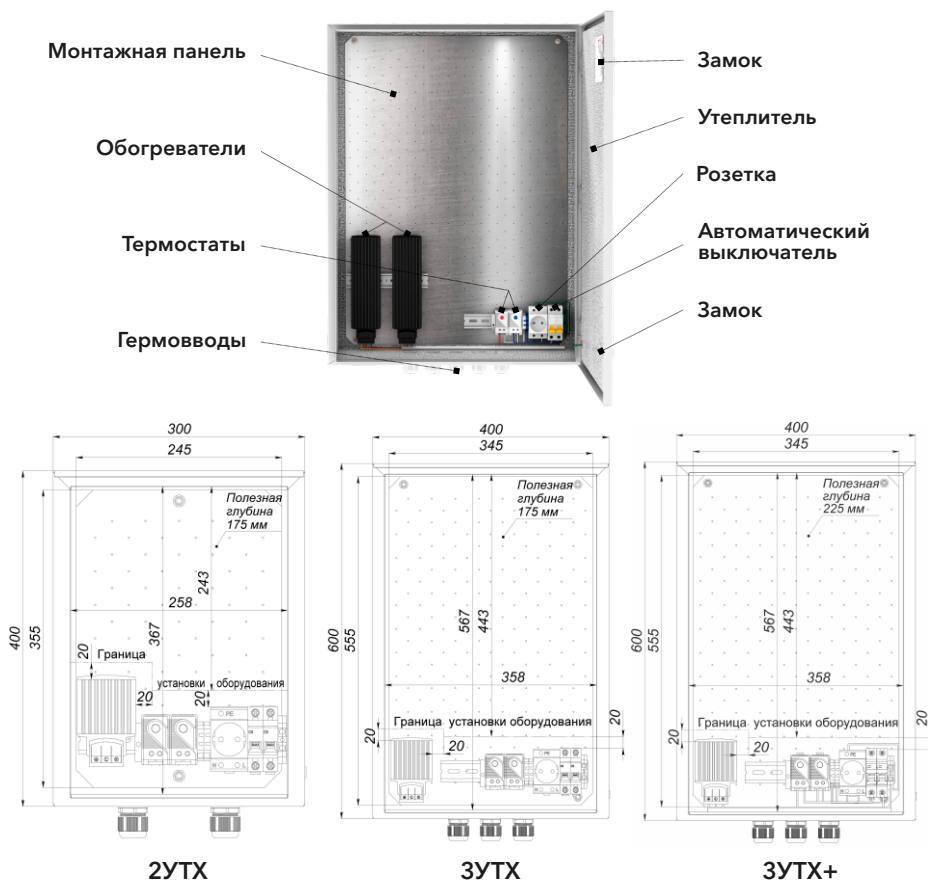
Схема компоновки и устройства шкафа
